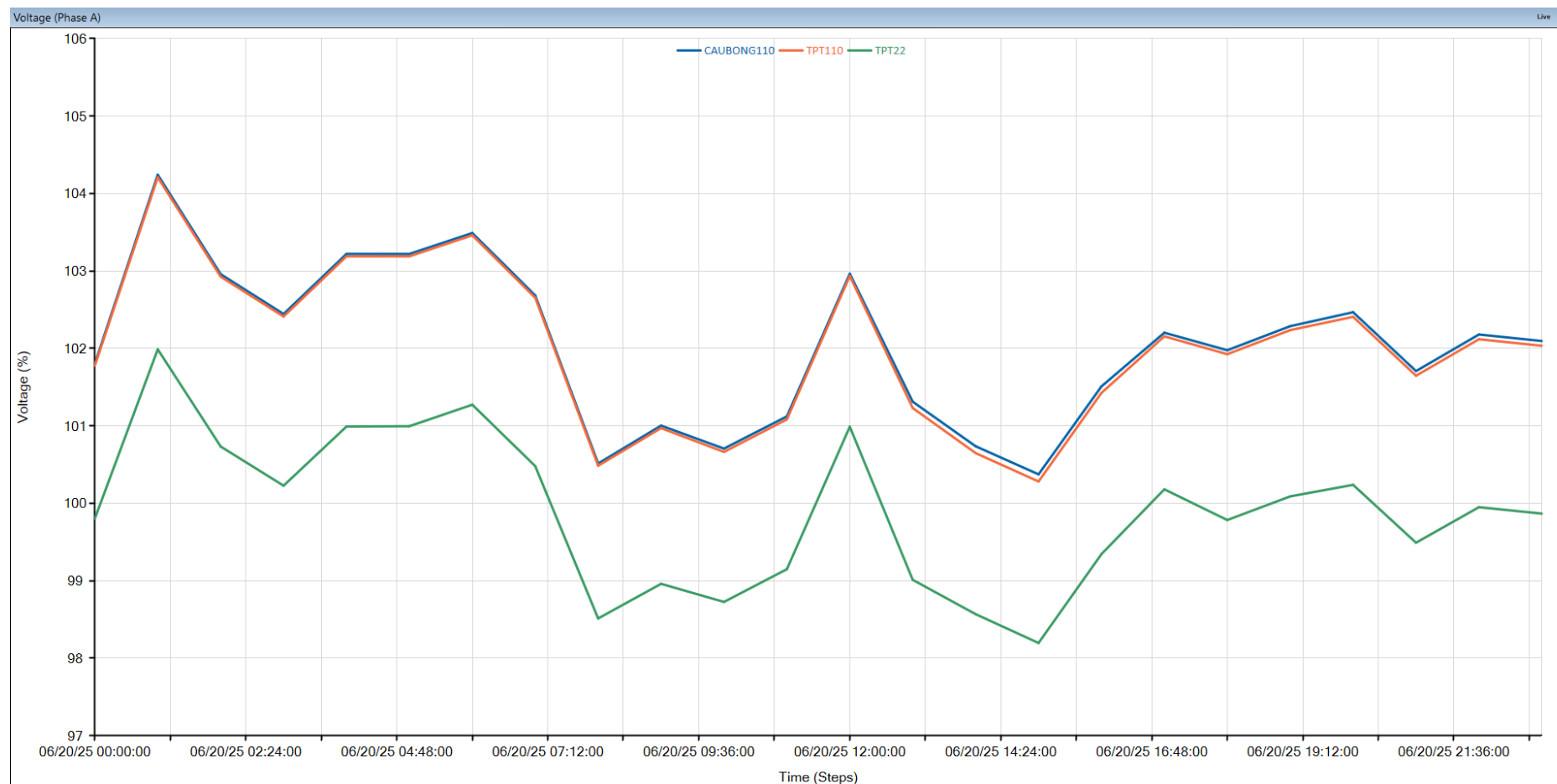
Hình 8. Điện áp các TC 22kV, 110kV trạm biến áp 110/22kV Tân Phú Trung và TBA 220kV Cầu Bông
