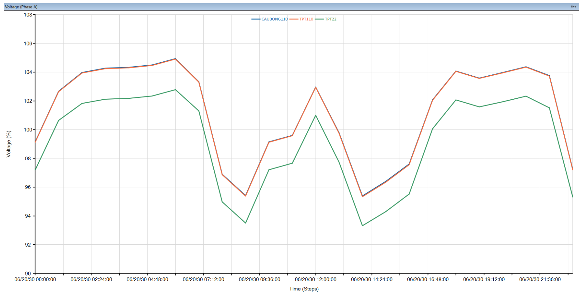
Hình 15. Điện áp các TC 22kV, 110kV TBA 110/22kV Tân Phú Trung và TBA 220kV Cầu Bông
