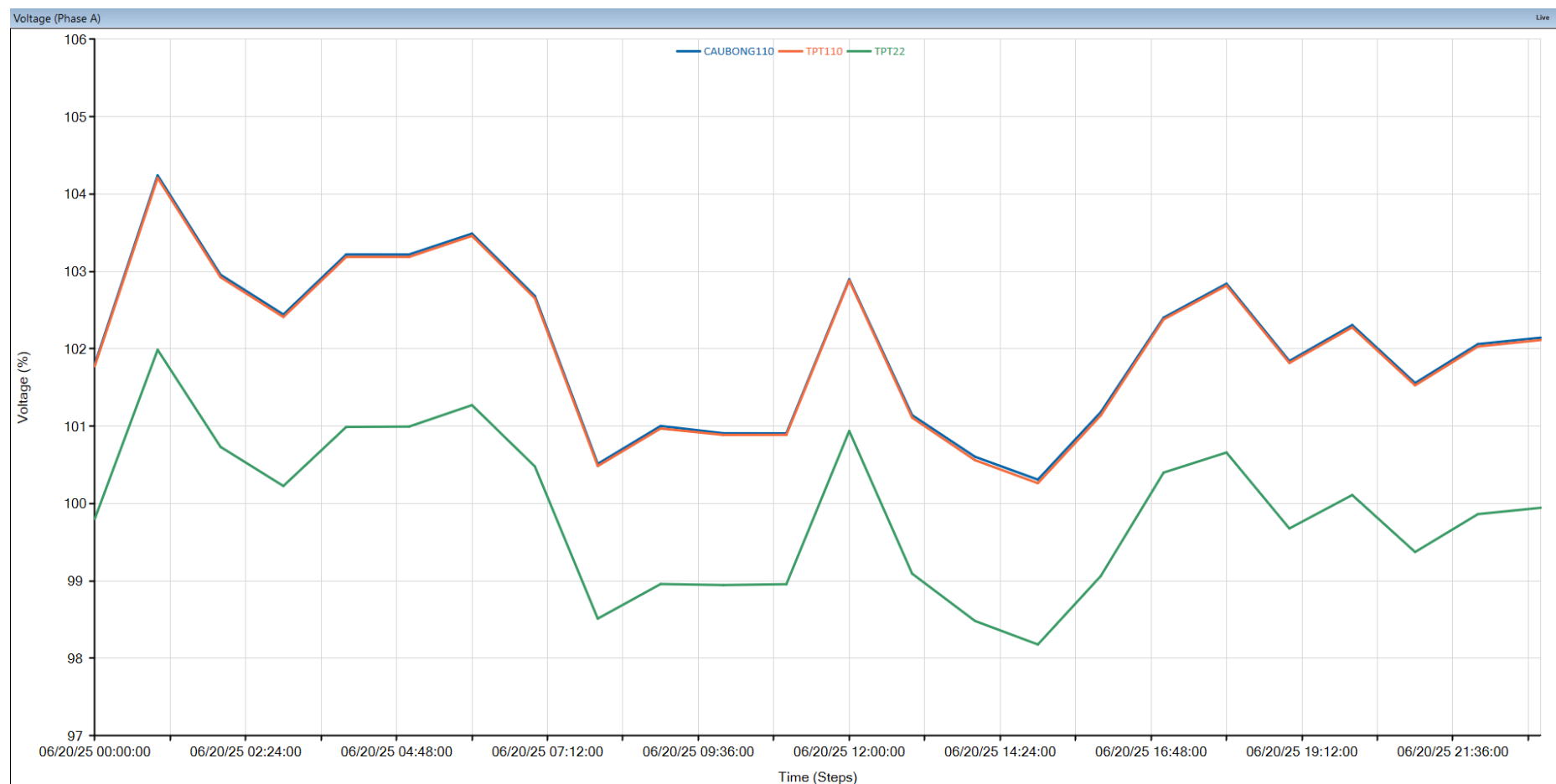
Hình 4. Điện áp các TC 22kV, 110kV trạm biến áp 110/22kV Tân Phú Trung và TBA 220kV Cầu Bông
